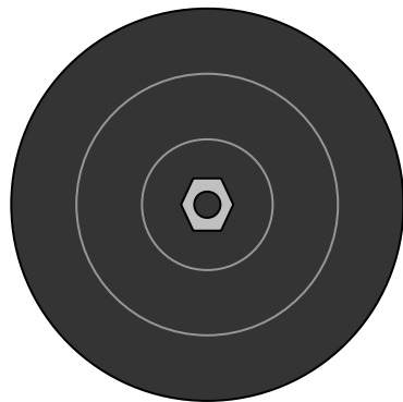
Gleichstromlichtmaschine (Zylindrische Form, Gehäuse ist bei Draufsicht von Riemenscheibe verdeckt, Stromstärke max. 45 A )
